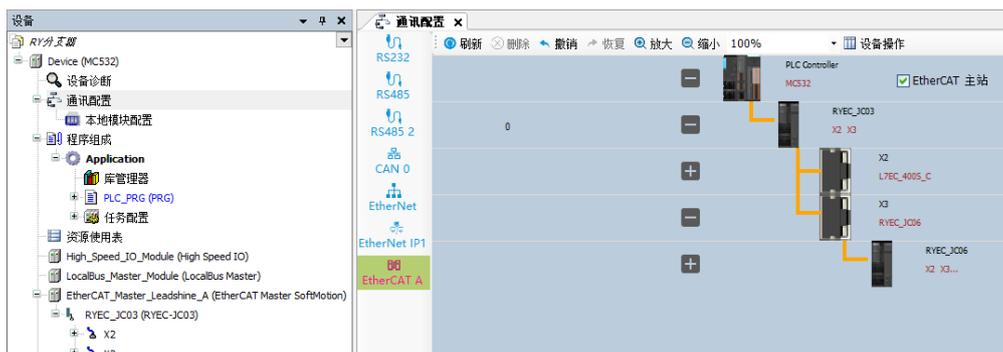
2) 自动扫描：将测试设备上电，使用 LeadSys 软件新建工程并连接 PLC，右键“EtherCAT\_Master\_Leadshine\_A”，选择“扫描设备”，如下图所示。
